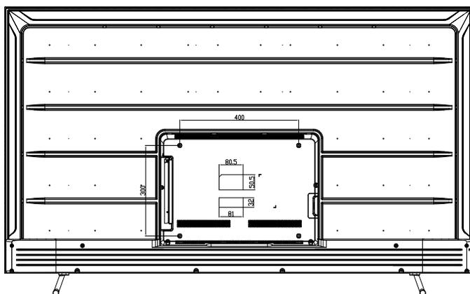
Ce téléviseur JVC est compatible avec un motif de trou de montage de 300 mm x 400 mm.
