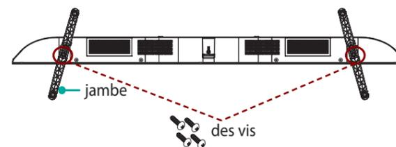
2. Placez le pied dans les fentes inférieures du téléviseur, insérez et serrez les vis (qui se trouvent dans le sac d'accessoires) dans les zones encerclées à l'aide d'un tournevis (non fourni).
